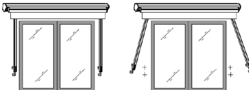
2. Utiliser un foret de 8 mm afin de percer 4 trous pour les fixations au niveau de vos marquages mur.
