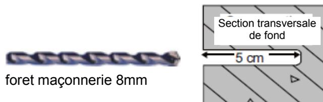
Ins é rez un tube d' expansion de plastique  $\varnothing 8 \times 45$  mm dans chacun de trous.
