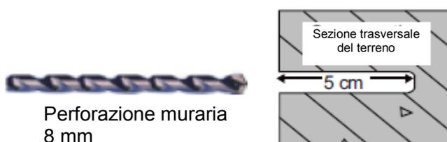
Inserire un tubo di espansione di plastica 8x40mm in ciascun foro.
