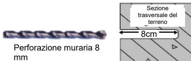
Inserire un tubo di espansione di ferro in ciascun foro.
