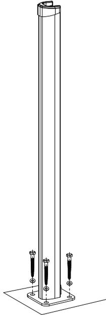
7. Richten Sie das linke untere Loch der Ständersäule und das Loch im Boden aus und ziehen Sie sie mit der Sechskantschraube M8 x 75 fest.
