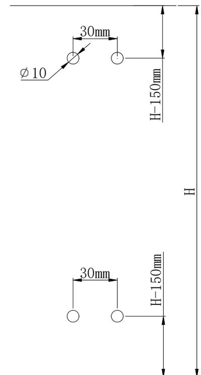
2. Einen  $\text{Ø}10 \times 50 \text{ mm}$  Kunststoffdübel in jedes der Löcher einführen.
