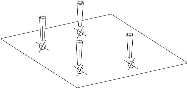
6. Setzen Sie in jedes der Löcher einen Ø10 x 50 mm großen Kunststoffdübel (4 Stück) ein.
