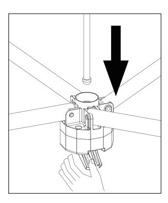
3. Entra nella parte inferiore del tettuccio, ruota in senso antiorario il mozzo inferiore centrale per sbloccare il telaio.
