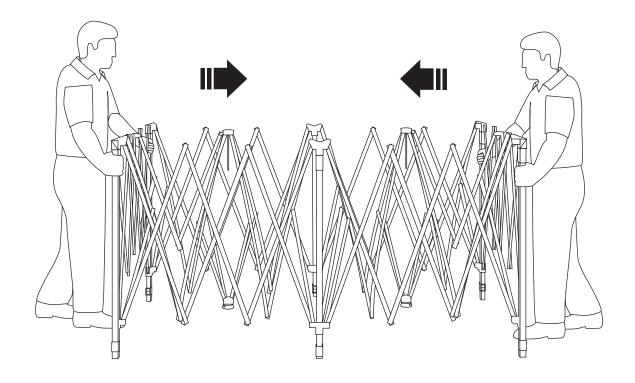
4. Sollevare un angolo del telaio finché tutte le gambe non sono sollevate da terra tranne la gamba 1 sull'angolo opposto. Spingere verso l'interno fino a quando il telaio è completamente chiuso.
