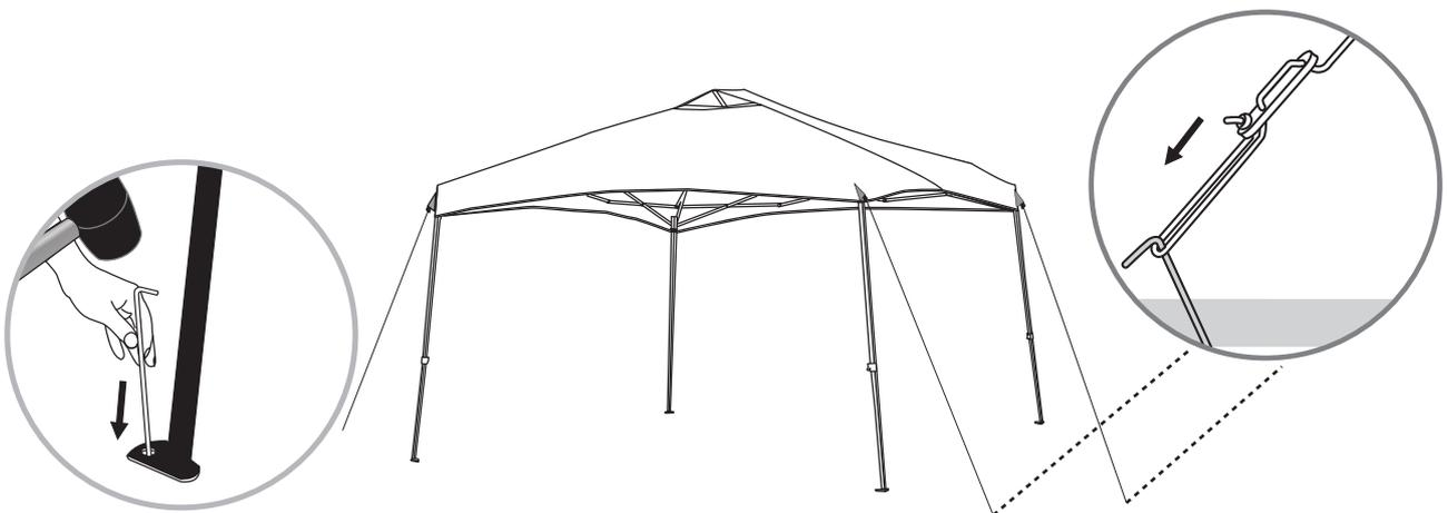
5: Attachez les cordes aux anneaux en plastique de l'auvent et attachez les cordes aux piquets dans le sol. Assurez-vous que les cordes ont la tension appropriée en ajustant les régleurs en plastique sur les cordes.
