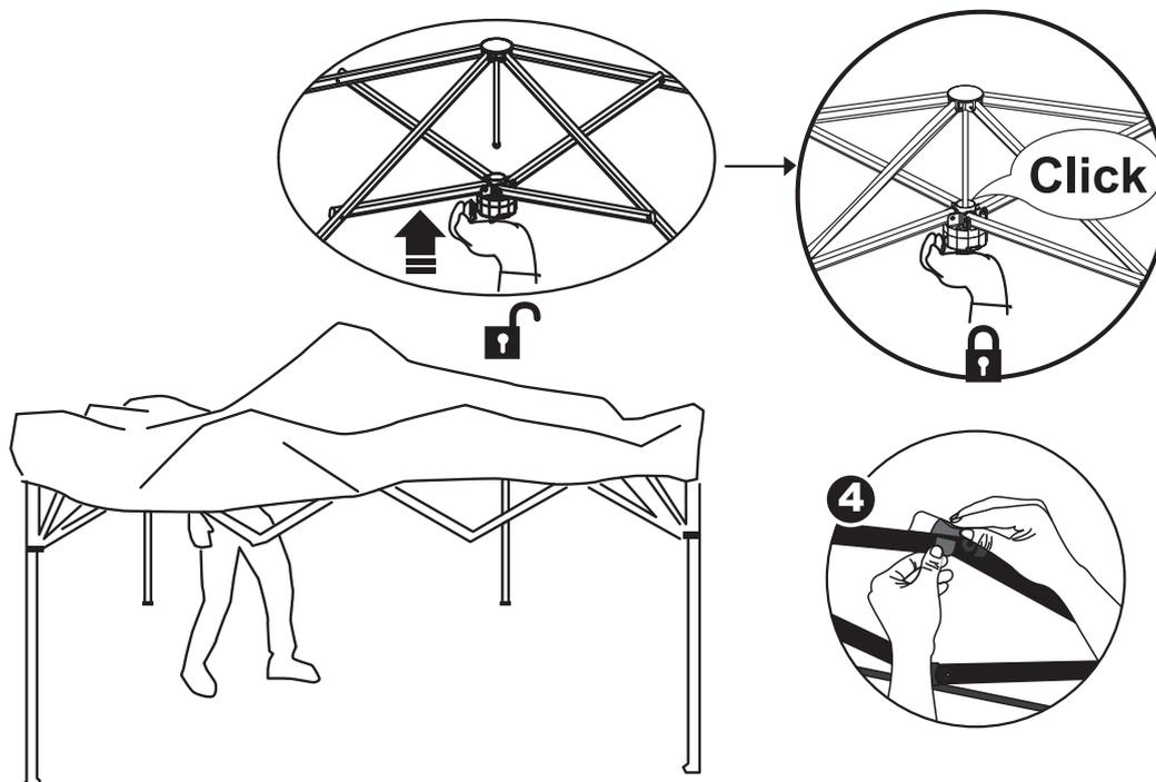
3: Sous l'auvent, placez une main sur le cadre supérieur et utilisez l'autre main pour pousser le moyeu central vers le haut jusqu'à ce qu'il s'enclenche dans le mât central. Terminez de fixer la grande verrière à l'intérieur du cadre de l'auvent à l'aide des boucles Velcro.
