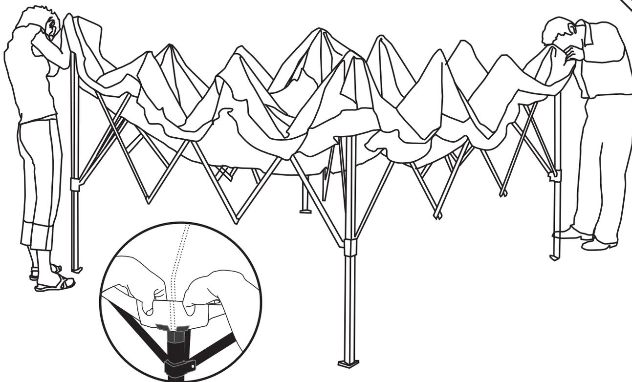
2: Dépliez le grand toit de la verrière et placez-le sur le cadre ouvert. Fixez les quatre coins de la verrière au coin supérieur du tube de jambe.
