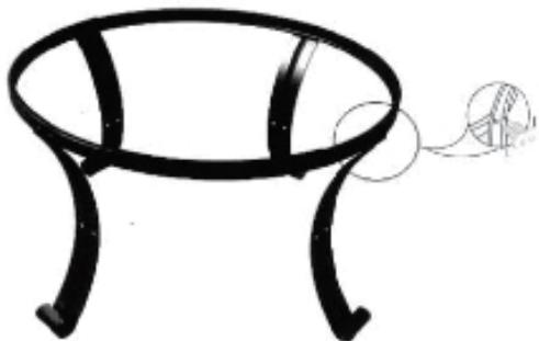
**Passaggio 2)** Fissare e serrare l'anello di sostegno piccolo a ogni gamba, utilizzando i bulloni (I) e il dado (J). Serrare completamente tutti i bulloni.
