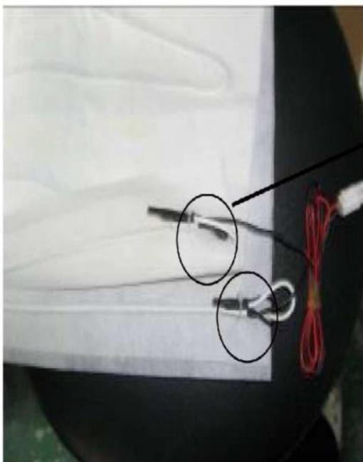
**Das Heizthermostat muss mit dem Heizungskabel verbunden sein, nur so kann eine Überhitzung ausgeschlossen werden. Entfernen Sie niemals das Thermostat, trennen Sie das Thermostat nie vom Gerät!**
