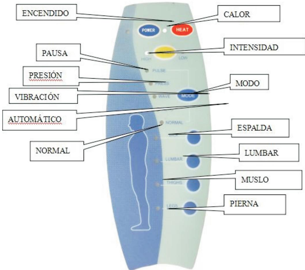
Este masajeador es compuesto por un tablero de control manual, una varilla de alambre y un motor. Tiene 5 modos funcionales, y cuenta con función manual / automática, función de calor, control de tiempo y función de control fuerte / débil.
