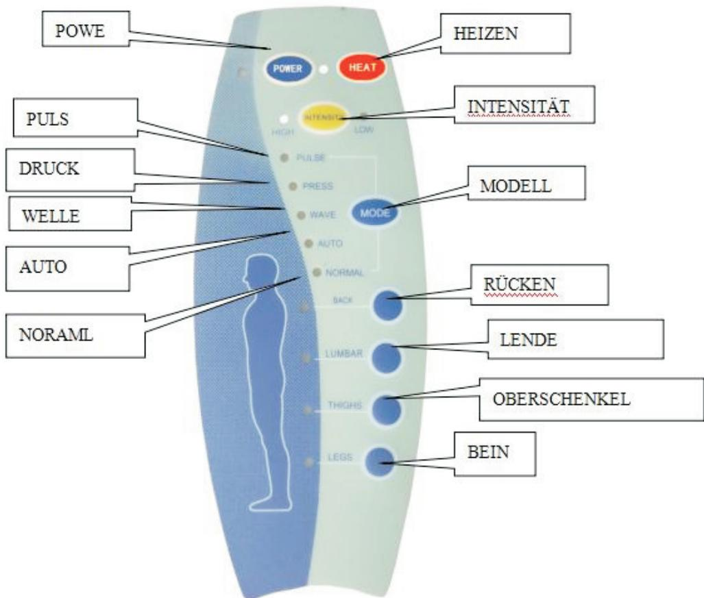
Dieses Massagegerät besteht aus einer manuellen Steuerung, Walzdraht und Motor. Es ist verfügbare in 5 Funktionsweisen und ist mit Manuell/Automatik-Funktion, Hitzen, Zeitsteuerung und Sträken/Schwächen Steuerfunktion versehen.
