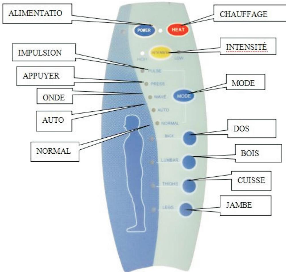
Il est composé d'un tableau de commande manuel, d'un fil machine et d'un moteur. 5 modes de fonctionnement sont disponibles, et il est fourni avec une fonction manuelle / automatique, chauffage, contrôle du temps et une fonction de contrôle fort / faible.
