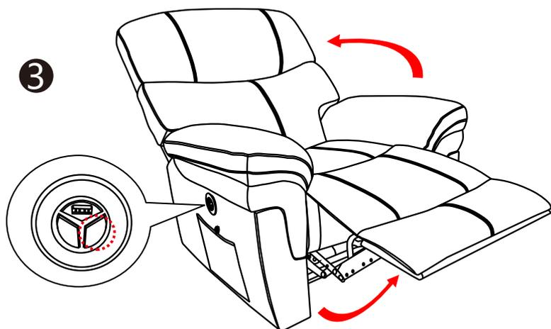
3) Wenn der elektrische Liegesessel zu arbeiten beginnt, wenn Sie ihn endlich einschalten und er nicht aufhört, bedeutet das dass die Pins falsch angeschlossen werden. Wenn dies der Fall sein sollte, schalten Sie bitte die Stromversorgung aus und schließen Sie die Pins wieder an.
