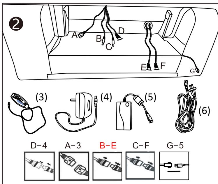
2) Die Pins müssen korrekt angeschlossen sein.
