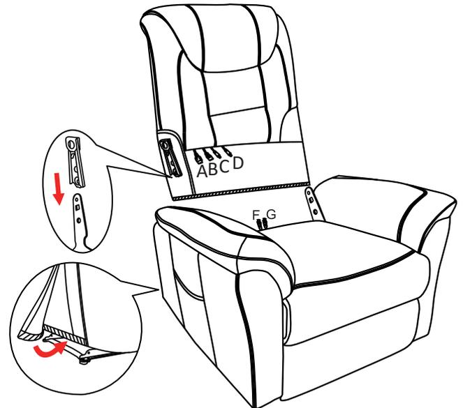
2) Positionieren Sie die Rückseite (siehe Punkt 1). Verbinden Sie die Stifte des Lift und Recliner-Versorgungskabels.
