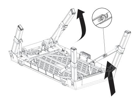
2. Ziehen Sie jedes Bein nach oben und nach außen - fahren Sie den Klappbügel aus, bis er einrastet.
