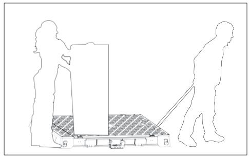
An einem Ende des Produkts befinden sich zwei Löcher zur Befestigung eines Zugseilverbinders, wenn Sie schwerere Gegenstände bewegen. Seien Sie vorsichtig, wenn Sie schwere Gegenstände transportieren.
