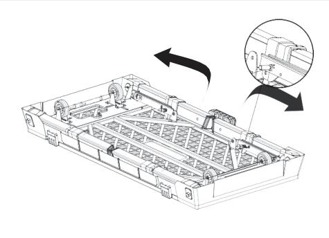
1. Beim Öffnen der Beine müssen Sie die federbelasteten Verriegelungsstifte herausziehen, da sie sonst beschädigt werden können und sich möglicherweise nicht öffnen lassen.
