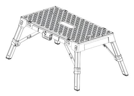
3. Nehmen Sie die Platte ab und drehen Sie sie um, so dass die Oberfläche nach oben zeigt. Legen Sie sie wieder auf die Plattform und schließen Sie alle vier Verriegelungen wieder.
