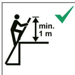
Les échelles utilisées pour accéder à un niveau supérieur doivent être prolongées d'au moins 1 m au-dessus du point de chute et sécurisées, si nécessaire. Lorsque l'échelle à charnière est utilisée comme équipement d'accès à un niveau supérieur, l'échelle doit être sécurisée contre tout glissement latéral involontaire.
