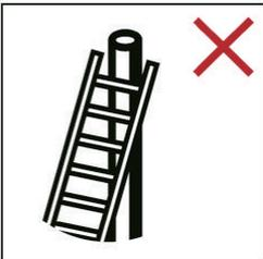
Ne pas appuyer l'échelle contre des surfaces inadaptées
