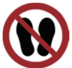
Jede horizontale Fläche, die wie eine Plattform auf einer Stehleiter aussieht, aber nicht zum Stehen bestimmt ist (z. B. eine Arbeitsplatte aus Kunststoff), muss auf dieser Fläche deutlich gekennzeichnet sein (nur wenn dies aufgrund der Konstruktion der Leiter erforderlich ist).
