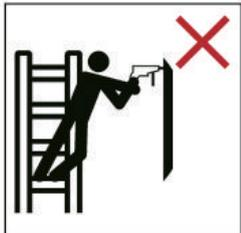
u) Vermeiden Sie Arbeiten, bei denen die Leiter seitlich belastet wird, wie z. B. das seitliche Bohren durch feste Materialien (z. B. Ziegel oder Beton);
