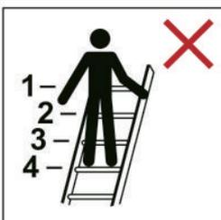
Stehen Sie nicht auf den obersten vier Stufen/Sprossen einer Stehleiter mit einer ausziehbaren Leiter an der Spitze.
