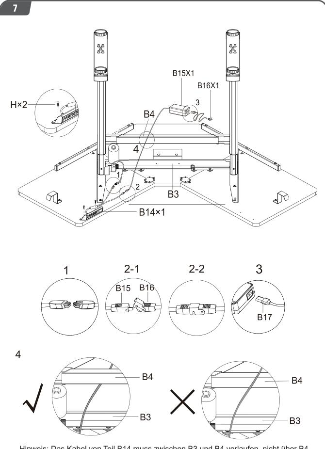
Hinweis: Das Kabel von Teil B14 muss zwischen B3 und B4 verlaufen, nicht über B4, sonst wird das Kabel von B14 beschädigt, so dass das Produkt nicht nach oben oder unten gehoben werden kann.
