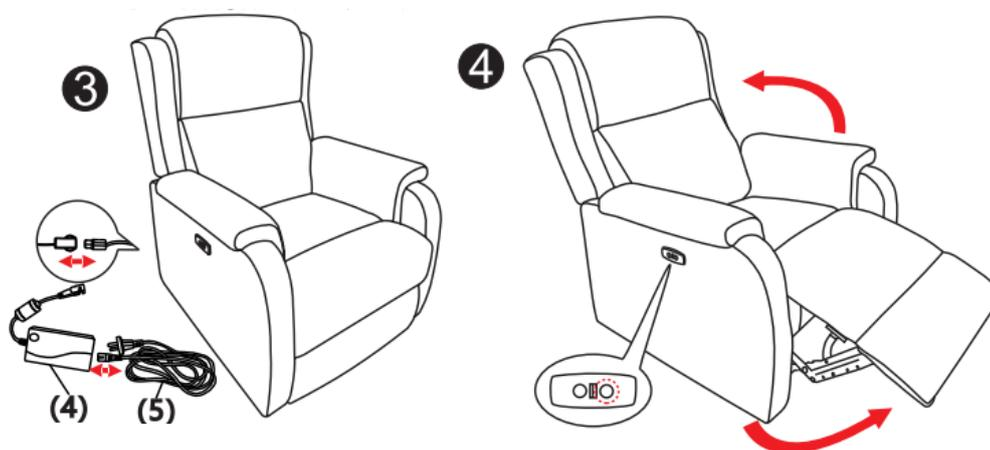
3) Collegare i jack del cavo di alimentazione per il massaggio, l'alimentazione l'adattatore. Montare correttamente i jack nel modo mostrato nell'immagine. Non forzarli, hanno solo una posizione corretta.
