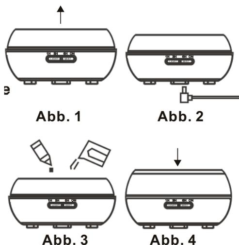
5. Bitte verbinden Sie das Netzgerät mit der Netzsteckdose des Familiennutzers.
