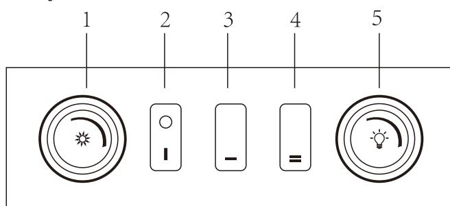
1. Bouton de commande du thermostat (**RÉGLAGE DE LA TEMPÉRATURE**): Réglez-le pour maintenir la température ambiante.
