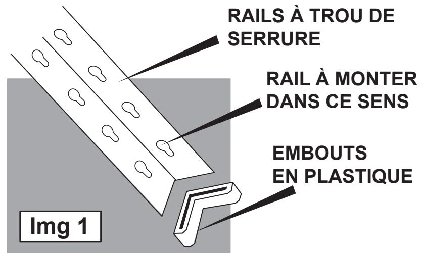
2. À l'aide de quatre rails à trous de serrure, placer deux supports d'étagère courts et deux supports d'étagère longs dans les trous de serrure inférieurs (pour une résistance maximale) en insérant les goupilles des supports dans les trous de serrure des rails - taper fermement avec un maillet pour les fixer en place (image 2).
