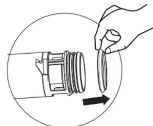
Entfernen Sie den Dichtungsring des Spülventils und säubern oder ersetzen Sie diesen.
