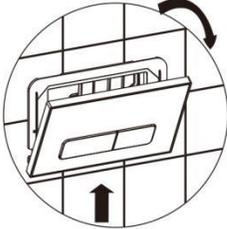
Drücken Sie die Unterseite der Drückerplatte nach oben und kippen Sie die obere Kante der Drückerplatte etwa 30 Grad nach außen, um diese herausnehmen zu können.
