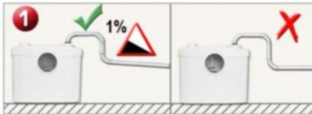
Wenn das Abwasser nach oben abgeleitet wird, sollte das horizontale Rohr nicht länger als 30 cm (1 ft) sein.
