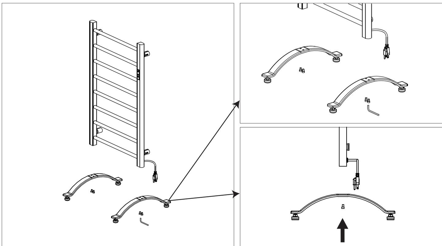
Passo 1. Avvitare la vite attraverso il telaio nella struttura principale del prodotto e stringere con la chiave a brugola.
