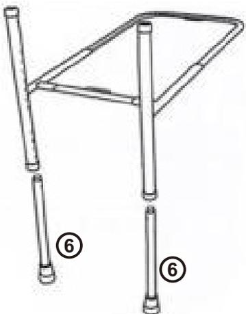
Verbinden Sie die Rohre mit dem Verbindungstück 2. Achten Sie dabei auf die richtige Höhe und stellen Sie sicher, dass die beiden Rohre auf der gleichen horizontalen Linie liegen.
