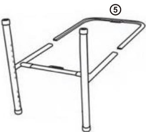
Verbinden Sie die Teile 2 und 3 anhand der Teile 5. Achten Sie darauf, dass der Verschluss in der Bohröffnung befestigt ist.
