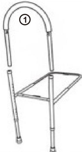
Montieren Sie die Handgeländer und vergewissern Sie sich, dass der Verschluss im Rohr eingerastet ist und die richtige Höhe eingestellt ist.
