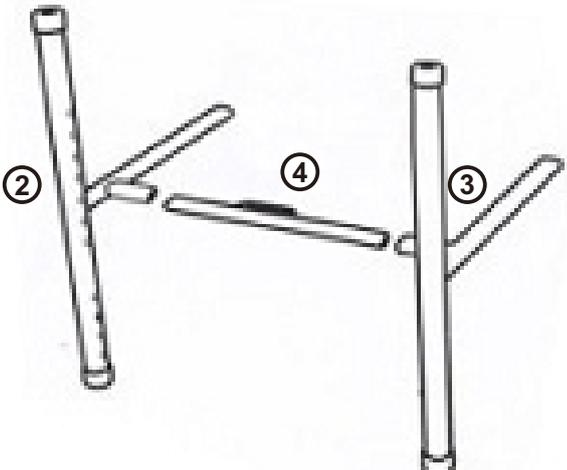
Verwenden Sie Teil ④, um Teil ② und Teil ③ zu verbinden, stellen Sie sicher, dass der Verschluss in der Bohröffnung befestigt ist.
