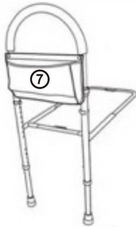
Hängen Sie die Tasche auf und befestigen Sie den Klettverschluss am linken und rechten Rohr (**Packen Sie nicht mehr als 5 kg**)
