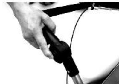
Setzen Sie das Vorderrad in den Rahmen des Anhängers ein und ziehen Sie die zwei Schrauben fest.
