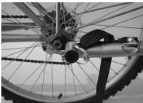
Verbindung mit dem Fahrrad mittels Schnellentriegelung
