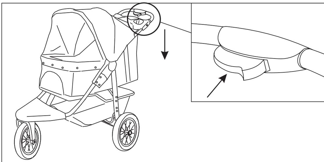
8. Klappen Sie den Kinderwagen zusammen: Öffnen Sie zuerst das Vordachfenster und drücken Sie dann den Klappknopf als Pfeilrichtung, um den Kinderwagen zu klappen und den Klapphaken zu befestigen.
