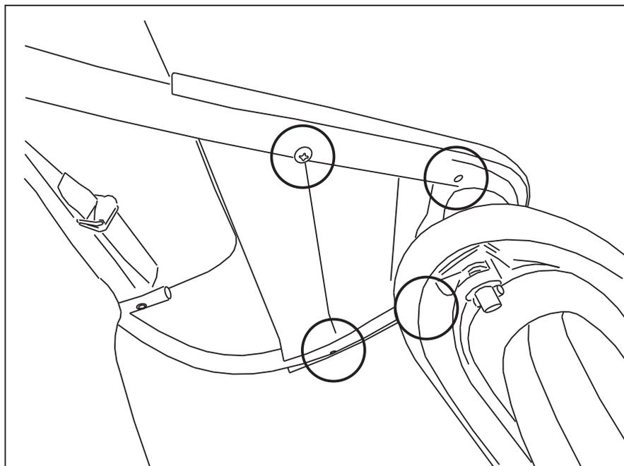
4. So befestigen Sie das Trittbrett: Befestigen Sie die Trittbrettposition unten und ziehen Sie die Schrauben fest.
