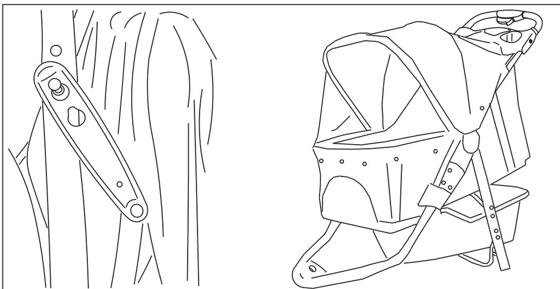
1. So öffnen Sie den Kinderwagen: Lösen Sie den Klapphaken wie in der Abbildung gezeigt, heben Sie den Lenker an, klappen Sie den Kinderwagen auf und stellen Sie sicher, dass beide Gelenke verriegelt sind.
