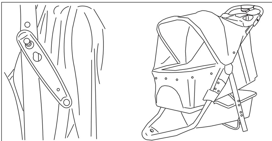
1. Pour ouvrir la poussette : relâchez le crochet pliant comme indiqué sur la figure, soulevez le guidon, déployez la poussette et assurez-vous que les deux joints sont verrouillés.
