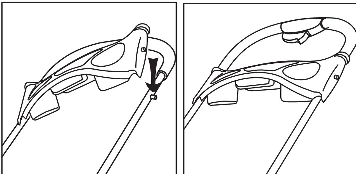
5. Pour fixer le porte-gobelet : visez le pieu sur le tube de poignée et visez le piquet sur le tube de la poignée et fixez le porte-gobelet.
