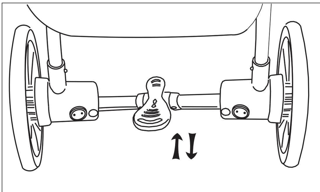
6. Treten Sie den Bremspol herunter, um den Kinderwagen anzuhalten, und heben Sie ihn an, um die Bremse zu lösen.
