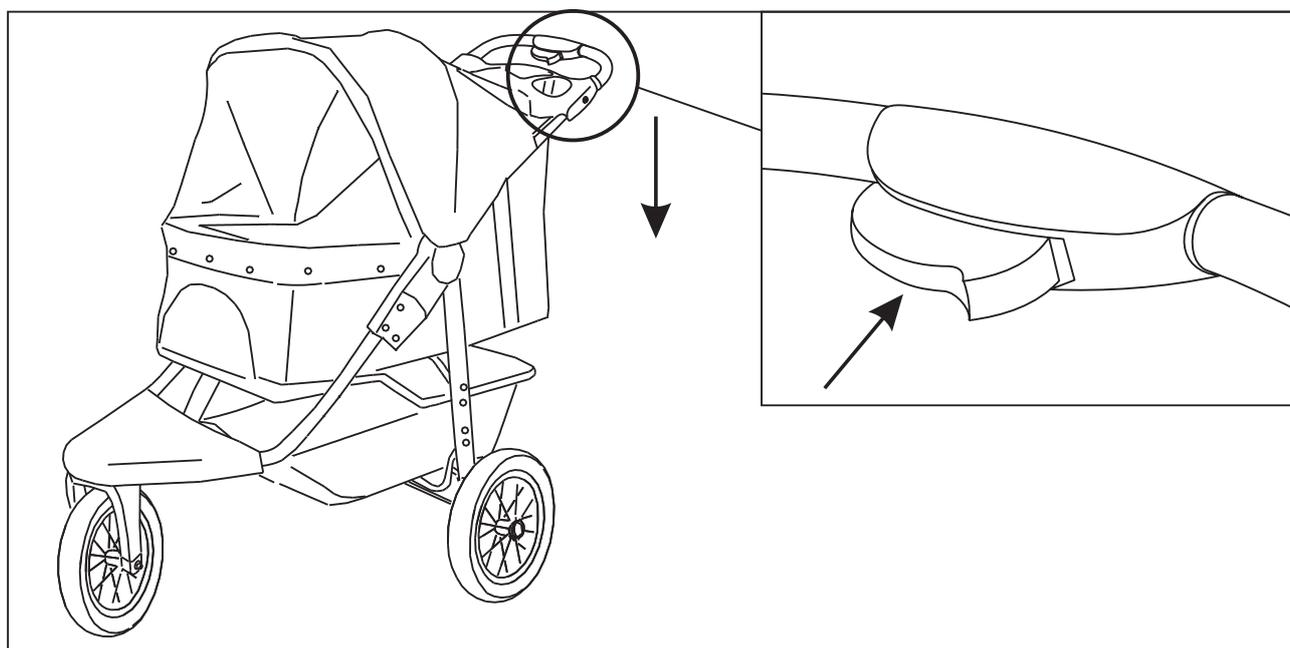
8. Plier la poussette : ouvrez d'abord la fenêtre de la capote, puis appuyez sur le bouton de pliage dans le sens de la flèche pour plier la poussette et fixer le crochet de pliage.
