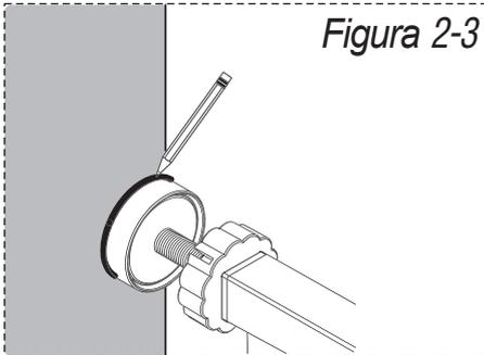
Una vez que usted esté satisfecho/a con la ubicación de su puerta de seguridad, mantenga las patas de goma de las varillas del eje sobre la superficie de la abertura, asegúrese de que estén niveladas (Figura 2-3). Entonces retire la puerta de seguridad de la abertura. Fije las 4 copas de pared a la pared con los tornillos (Figura 2-4), o péguelas en su lugar con las pegatinas provistas (Figura 2-5).
