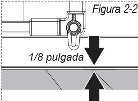
Coloque la puerta de seguridad en la abertura con la parte inferior cerca del piso. La distancia entre la parte inferior de la puerta de seguridad y el piso debe ser menor de 1/8 de pulgada (Figura 2-2).
