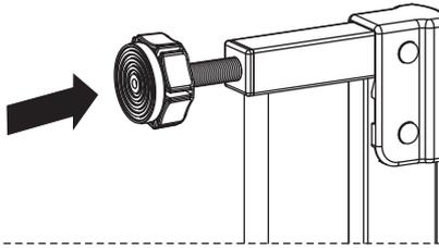
Inserte las varillas del eje roscadas con ruedas de ajuste en el orificio que está ubicado en las 4 esquinas de los lados de la puerta de seguridad (Figura 2-1).
