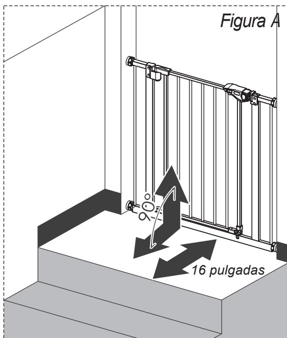
Si la puerta de seguridad se utiliza en la parte superior de las escaleras, se recomienda que la distancia segura al primer escalón sea de al menos 16 pulgadas. (Figura A)
