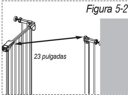
NOTA Cuando el ancho de la abertura de la puerta es mayor a 23 pulgadas, la puerta de seguridad se podrá abrir normalmente (Figura 5-2).
