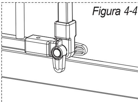
**Para abrir** - Asegúrese de que los cierres de base en la parte inferior de la puerta estén en posición horizontal (Figura 4-1). Tire del cierre de resorte para separarlo del pestillo de abertura fácilmente, al mismo tiempo levante la palanca del cierre hacia arriba (Figura 4-2 y 4-3). Entonces se liberará el pestillo de cierre del marco de la puerta de seguridad y lo que permitirá que se empuje o se tire de la puerta para abrirla.
