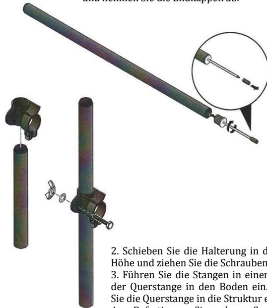
2. Schieben Sie die Halterung in die gewünschte Höhe und ziehen Sie die Schrauben fest.
