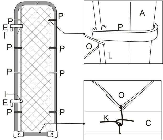
Installare la rete di collegamento a maglie sul telaio del cancello, inserire le due barre circolari nei bordi della rete, quindi utilizzare 4 paia di ganci per collegare le barre circolari e i tubi. Infine, utilizzare il filo di legatura per fissare la rete a maglie al telaio del cancello, rendendolo rigido e resistente.
