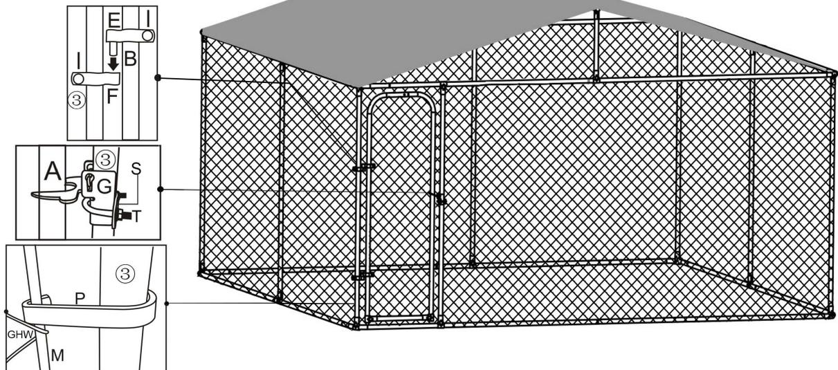
Utilizzare i cardini della porta (e il set di viti grandi) per fissare la porta al telaio. Quindi installare il morsetto di sicurezza sulla pista per cani. Legare il filo di legatura per collegare la parte superiore e inferiore del cancello alla rete a maglie e rendere il cancello sicuro e resistente utilizzando la cacciavite e il trapano per inserire una vite autofilettante attraverso i fori pilota nei tubi, anche questo permetterà al cane di correre più forte.
