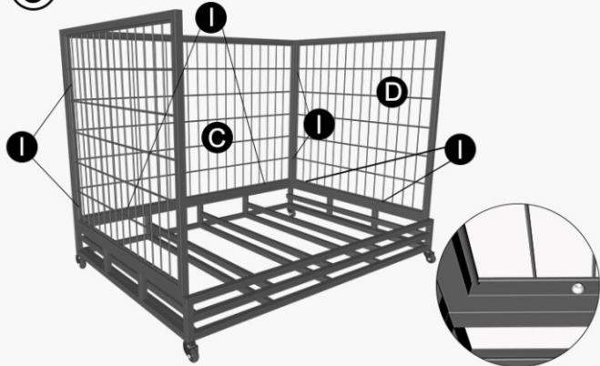
Installez la plaque arrière de la même manière, puis fixez la plaque arrière et les plaques latérales gauche et droite à l'aide de vis.
