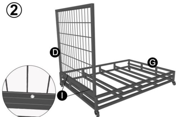
Setzen Sie den Bodenträger ein, nehmen Sie eine Seitenwand heraus und montieren Sie sie mit
