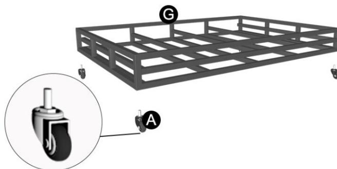
Monter les 4 roues universelles sur le châssis
