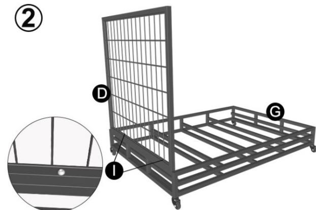
Posizionare il supporto della base, estrarre un pannello laterale e montarlo.
