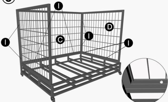
Bringen Sie die Rückwand auf die gleiche Weise an und befestigen Sie dann die Rückwand und die linke und rechte Seitenwand mit Schrauben.
