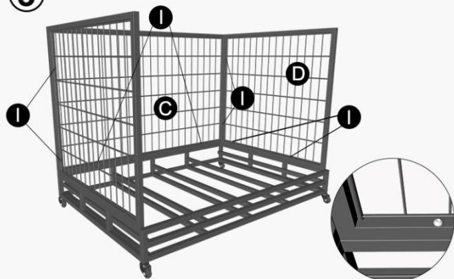
Installare il pannello posteriore allo stesso modo, e fissare il pannello posteriore e i pannelli laterali di sinistra e destra con le viti.
