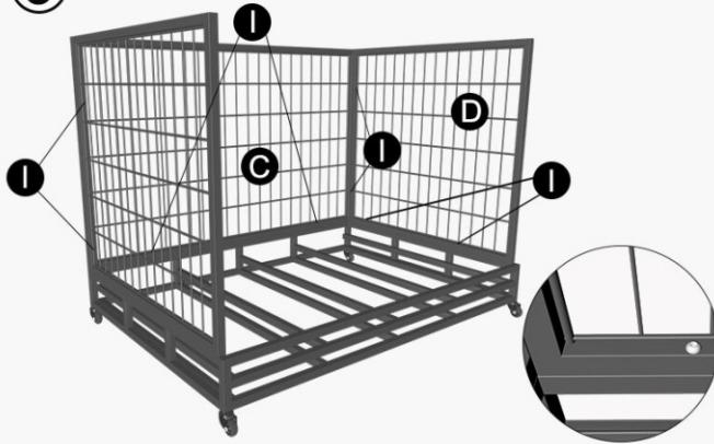
Instale el panel trasero de la misma manera, y luego fije el panel trasero y los paneles laterales izquierdo y derecho con los tornillos.
