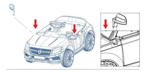
• Passen Sie die Schlitze im Spiegel an die Schlitze in der Karosserie an und drücken Sie den Spiegel in den Spalt.
