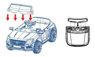
Überprüfen Sie den Schlitz und drücken Sie die Windschutzscheibe entsprechend der Schlitzposition zum Spaltende.
