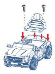
• Setzen Sie den Sitz gemäß der obigen Abbildung auf die Karosserie und ziehen Sie den Sitz mit einer Blechschraube Ø4 \* 20 fest.
