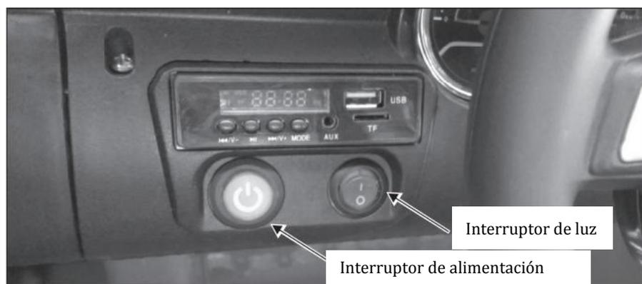
b) El interruptor de 1/0 es el interruptor de iluminación, gire el interruptor a "1" las luces, encienda el interruptor a "0" las luces apagadas.
