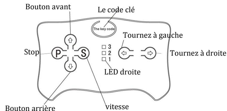
La télécommande doit toujours être utilisée avant les pédales (la pédale ne fonctionnera pas pendant l'utilisation de la télécommande).
