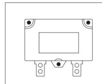
Fusible ajustable: lorsque le courant dépasse une certaine valeur, le fusible récupérable coupe automatiquement l'alimentation pendant 5 à 10 secondes, puis le courant est réapprovisionné.
