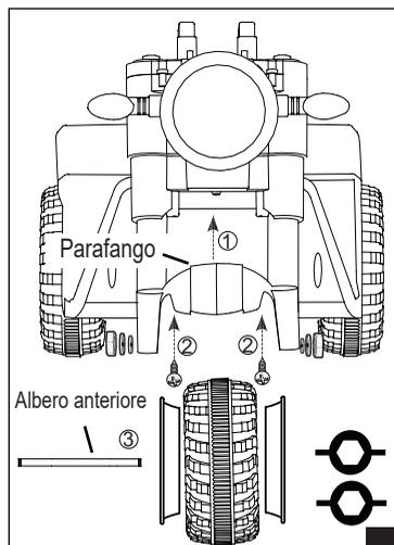
7. Assemblaggio del parafango(1). Usando 2 viti 4x12 per serrare (2).
