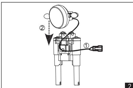
1. Assemblare la luce anteriore secondo la punta della freccia, utilizzando 2 viti 4x12 per serrare.
