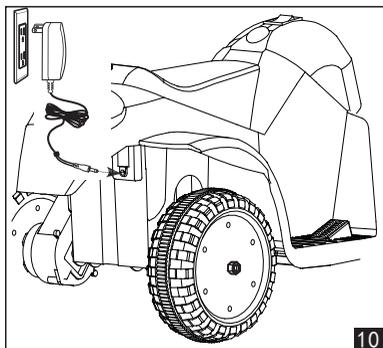
10. Carica della batteria: ricaricare il triciclo quando la batteria è scarica. L'ingresso jack si trova sul lato sinistro della ruota destra. Collegare il spinotto all'ingresso jack per caricare (10).
