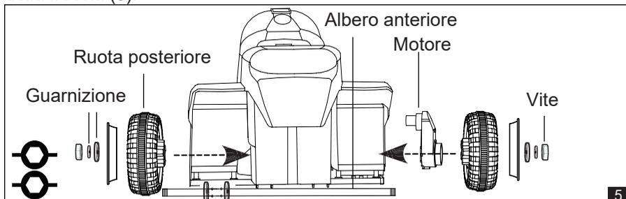
5. L'ordine di montaggio sull'albero posteriore per il lato sinistro: la ruota posteriore, il cerchione posteriore, la guarnizione, e la vite, per il lato destro: il motore, la ruota posteriore, il cerchione posteriore, la guarnizione, e la vite.
