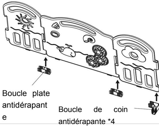
3. Installez la boucle plate antidérapante et la boucle de coin antidérapante : Comme indiqué sur la figure, attachez la boucle plate antidérapante au maillon de la pièce de clôture. Les bouton-pression anti-dérapants sont installés de la même manière dans les coins. (Les boucles plates sont installées en fonction du nombre réel)
