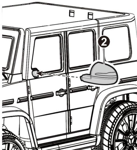
1. Insérez les languettes du pare-brise dans les rainures du véhicule. Installez les rétroviseurs latéraux dans les trous situés sur le côté des portes et appuyez jusqu'à ce que vous entendiez le « clic » en place.
