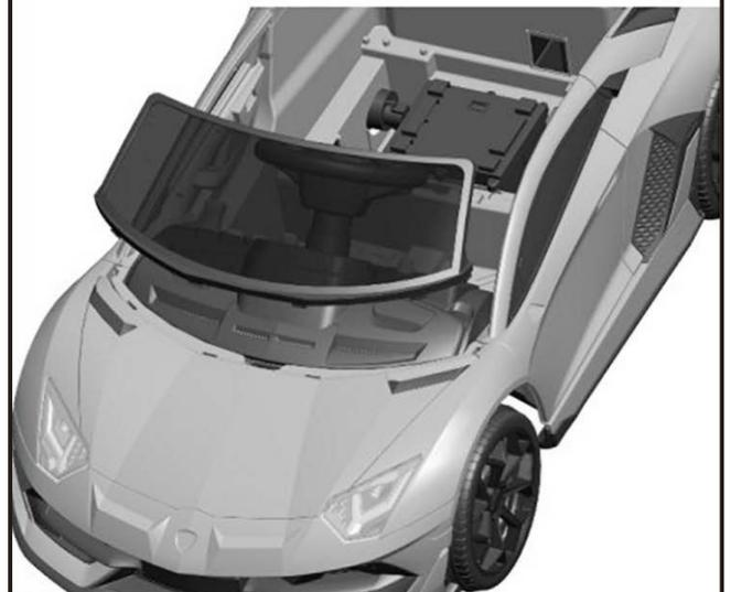
Placez les languettes de l'ensemble du pare-brise dans les fentes de la carrosserie. Poussez l'ensemble du pare-brise pour qu'il « s'enclenche » en place. Assurez-vous qu'il est bien fixé.
