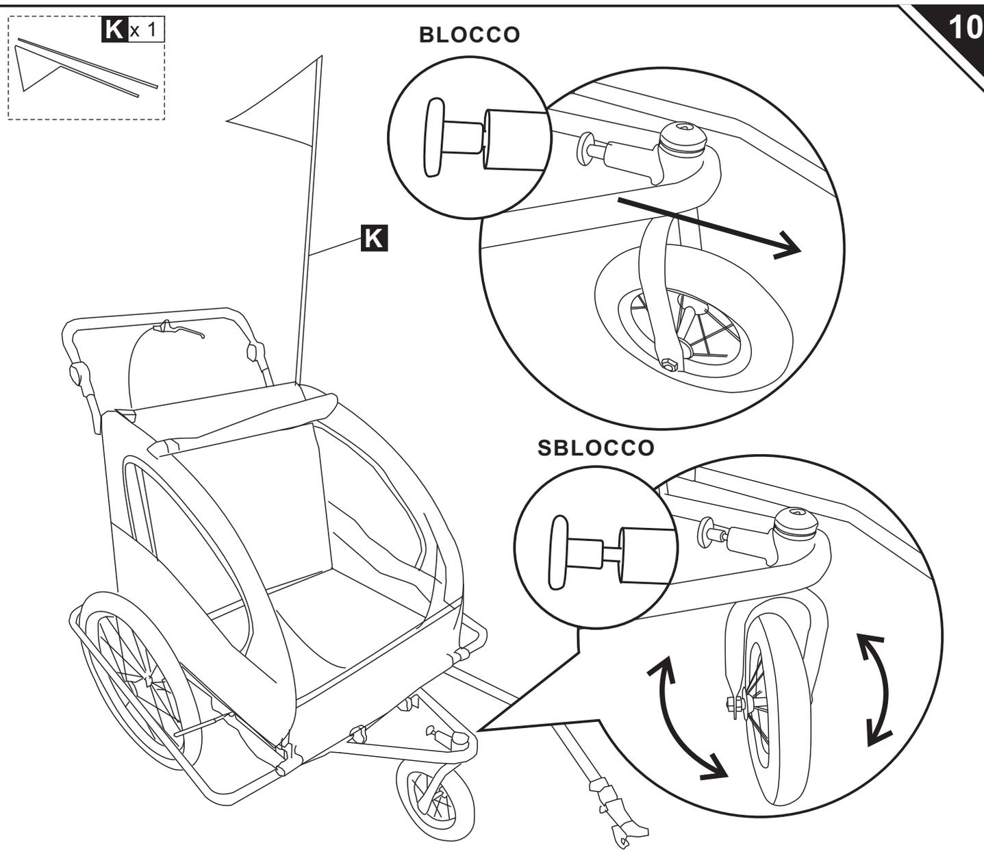
Il nodo nero può controllare le condizioni della ruota (blocco o sblocco) Tirare fuori e ruotare la il nodo nero, la posizione della ruota può essere controllata.
