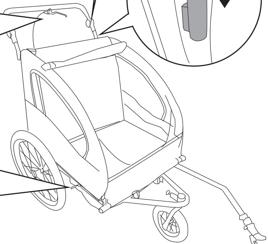
Il rimorchio bici è dotato di un freno sulla ruota, serrare strettamente la vite laterale, serrare anche il dado a 6 lati con strumenti. Il freno a mano può controllare il freno sulla ruota. Quando chiudi il freno a mano e premi la vite perché il rimorchio non possa andare avanti.
