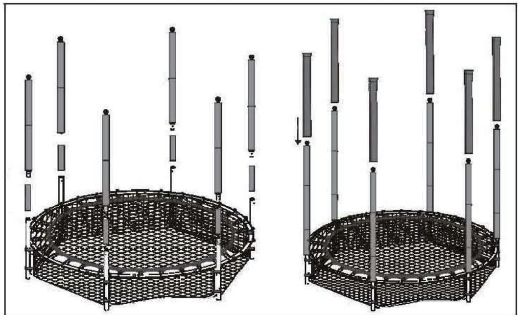
7. Fixez le filet du haut vers le bas jusqu'au support principal avec la boucle de fixation du filet sur l'embout supérieur et attachez la bande élastique au tuyau comme ci-dessous.
