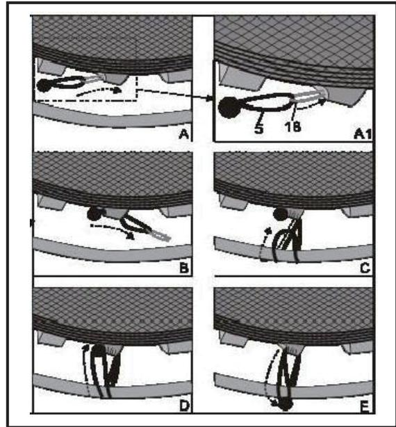
4. Placez le couvre ressorts sur le cadre du trampoline en positionnant soigneusement les 6 ouvertures dans le couvre ressorts, sur les prises de poteau correspondantes.
