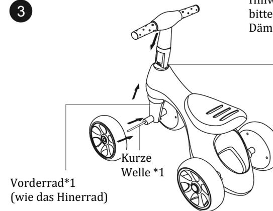
3. Lenker und Vorderrad einbauen: Wie in der Abbildung dargestellt, setzen Sie zuerst die kurze Welle durch das Vorderrad und verriegeln Sie dann das Rad. Legen Sie das Vorderrad durch das Loch auf dem Hauptkörper des Laufrads und setzen Sie dann die Vorderseite des Lenkers im Vorderrad.
