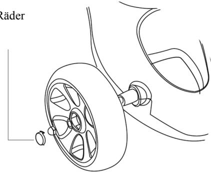
2. Abdeckung einbauen: Wie in der Abbildung dargestellt, die Abdeckung des Hinterrads fährt entlang der Richtungstaste in das Rad. Auf der anderen Seite die gleiche Operation.
