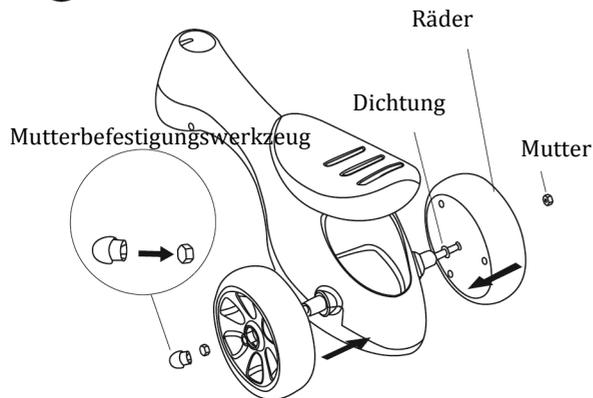
1. Welle nach dem Einbau des Hinterrades: wie in der Abbildung dargestellt, gleiten durch den Hauptkörper des Laufrads beide der Welle Ende. Wiederum fügen Sie mit einem Mutterbefestigungswerkzeug die Dichtung, das Rad, Mutter und Schraubmutter.
