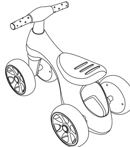
4. Überprüfen Sie: nach den oben genannten Schritten/nach der Installation überprüfen Sie den Lenker des Laufrads und Hauptkörper, ob alle befestigt sind. Überprüfen Sie ob das Radgetriebe funktioniert
