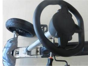
D. Fixez le volant sur la tige de direction et fixez-la avec la vis 5\*35
