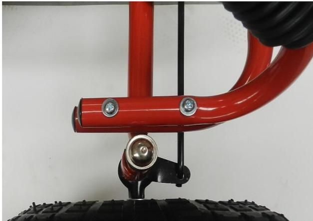
2. Fixez le siège au cadre du go-kart en utilisant les boulons **M5\*40mm** et assurez-vous d'utiliser les rondelles appropriées.
