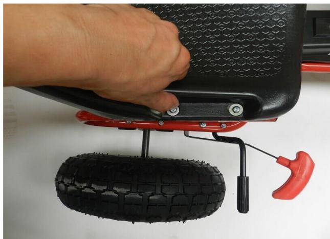
3. Insérez l'arbre de direction à travers le pôle tournant. Placez le panneau avant sur l'arbre de direction.
