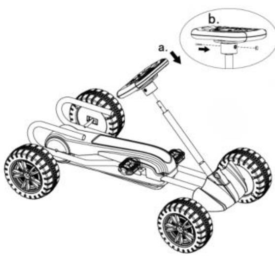
3. Placez le volant dans l'arbre de direction et fixz-le avec une vis M5 \* 40, puis bloquez-le avec un écrou de 5 mm.
