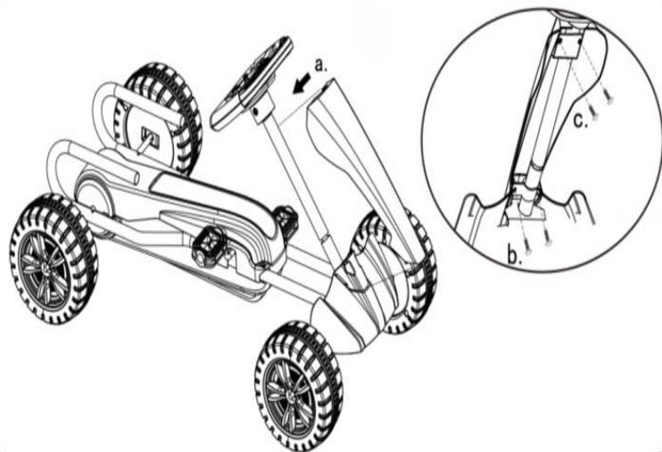
4. Assurez-vous que les 2 trous de vis du panneau et du châssis sont alignés pour fixer le panneau sur le châssis. Serrer avec la vis M4 \* 10. -- b
