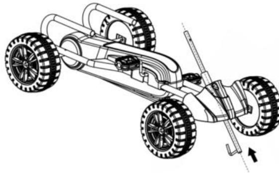
1. Mettez l'arbre de direction dans le trou situé à l'avant inférieur du kart. Accrochez l'arbre de direction à l'essieu tournant.
