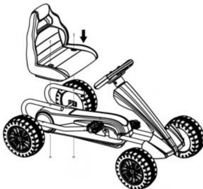
5. Fixez le siège au châssis du véhicule à l'aide des boulons M5 \* 55mm. Assurez-vous d'utiliser à nouveau les rondelles le cas échéant.
