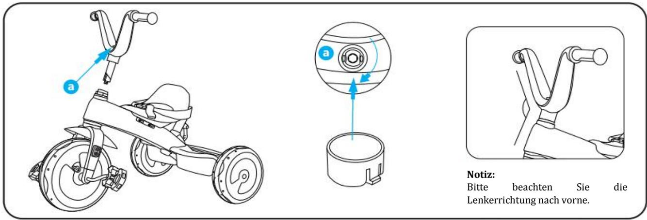
**3. WIE ABGEBILDET,** Lenkerrohr (9) in den Hauptrahmen stecken, Richtung einstellen, Schraube wie in Bild a anziehen, zuletzt die schwarze Kappe in ein Positionsloch stecken.
