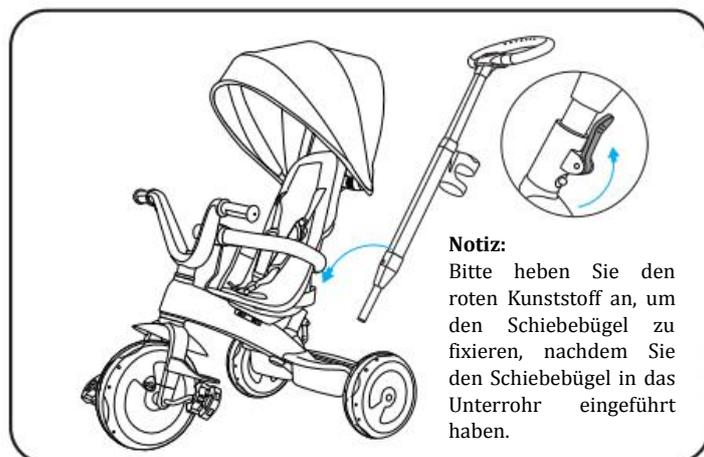
**7. WIE ABGEBILDET,** stecken Sie den Schiebebügel in das hintere Fallrohr, wenn Sie den Schlossgeräusch hören, das heißt fertig.
