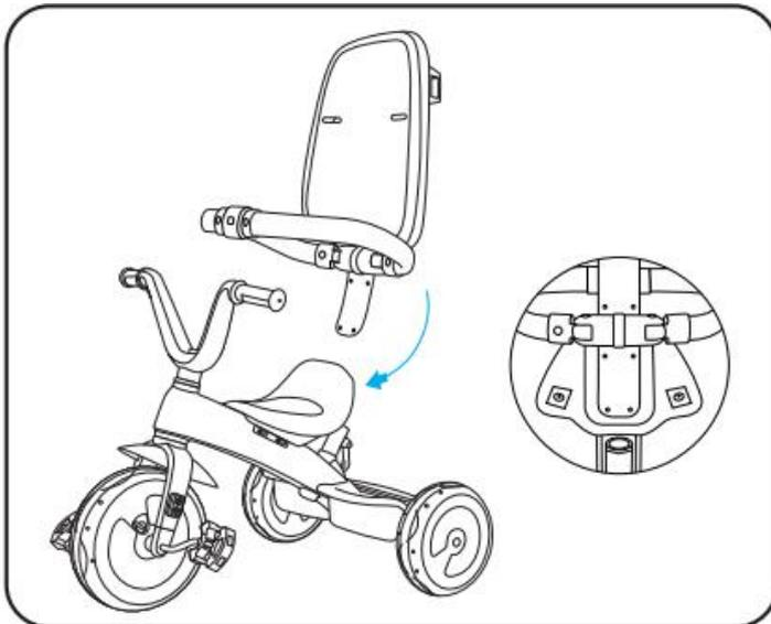
**4. WIE ABGEBILDET,** halten Sie das Loch der geistigen gleichen Position sowie das Loch des Sitzes, befestigen Sie mit Schraube, setzen Sie die vordere Fußstütze auf die Fußstütze Kunststoffträger.
