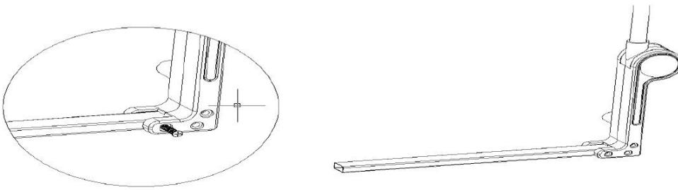
1. Öffnen Sie den Fixator der beiden linken und rechten Stützfüße um 90 Grad und befestigen Sie dann die Fixierhalterung mit der Befestigungsschraube F2.
