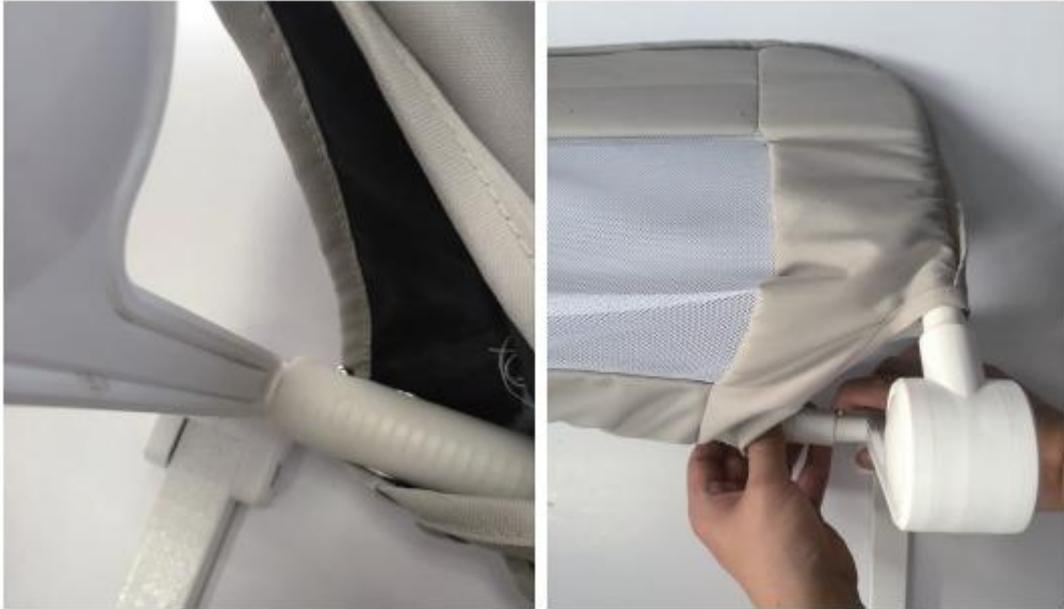
10. Wenn eine Demontage erforderlich ist, halten Sie die Federscheibe am Kunststoffende der Verbindungsstange der geraden Stange, schieben Sie den Kunststoff nach rechts und entfernen Sie ihn von der Stützfußhalterung. Halten Sie die Federscheibe ebenfalls am anderen Ende und ziehen Sie ihn direkt von der Stützfußhalterung ab.
