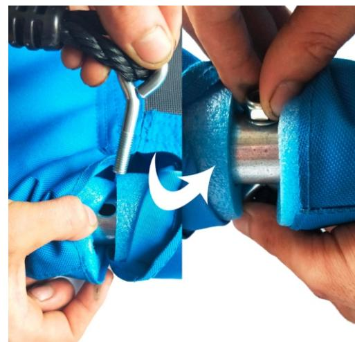
Insérez le boulon à vis dans les tubes de cadre.
