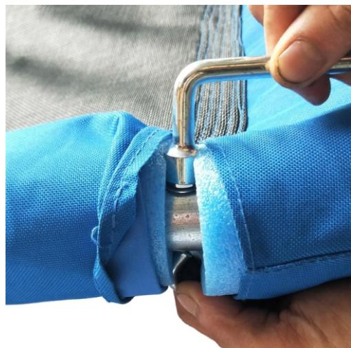
Serrez le boulon avec l'écrou (utilisez la clé fournie dans le paquet.) N'oubliez pas la rondelle de blocage.
