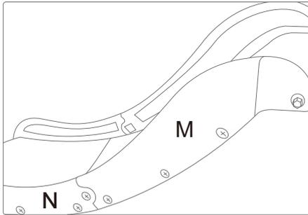
3. Installez la rampe de protection M, N sur un côté le long de la glissière.
