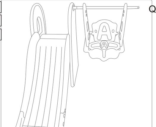
7. Installez la boucle à ressort dans les trous situés aux deux extrémités de la poutre, passez à travers la planche latérale de la balançoire, fixez-la avec la boucle de la balançoire, installez la boucle de connexion, et enfin fixez la planche latérale du toboggan.
