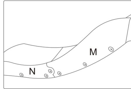
2. Installez la rampe de protection M, N sur un côté le long de la glissière
