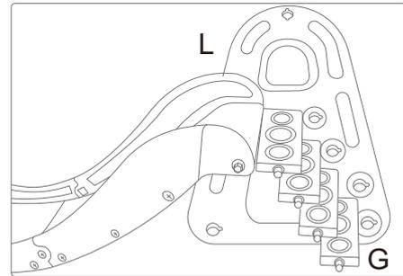
4. Installer la glissière et les pédales sur une planche latérale du toboggan, et serrer avec l'écrou en forme de fleur.
